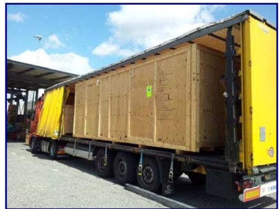
Die Maschine und Zubehörteile wurden beim Kunden vor Ort in Kisten verpackt. Dabei wurde dem Aspekt Korrosions- und Diebstahlschutz besondere Aufmerksamkeit geschenkt. Anschliessend wurden die Kisten auf insgesamt vier LKW verladen. Durch den Langzeitkorrosionsschutz (die konsequente Anwendung gehört bei T-LINK zum Standard) ist das Transportgut auch nach Eintreffen am Bestimmungsort, z.B. bei einer Lagerung auf einer Baustelle, weiterhin geschützt.
